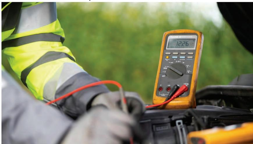
Mit einem Spannungsprüfer lässt sich der Ladezustand feststellen · © ADAC/Martin Hangen
